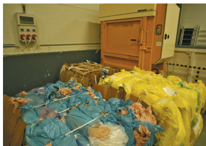
Háttérben a tömörítő gép, előtte az eredménye látható. A zsák színe a hulladék típusát is jelöli.
